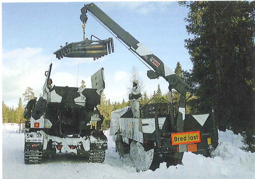
Omladdning med en ny kassett om 14 skott tog ett par minuter. Laddbommen som fanns på Bandkanon 1A och B för att lyfta i magasinet togs bort på C-versionen.
