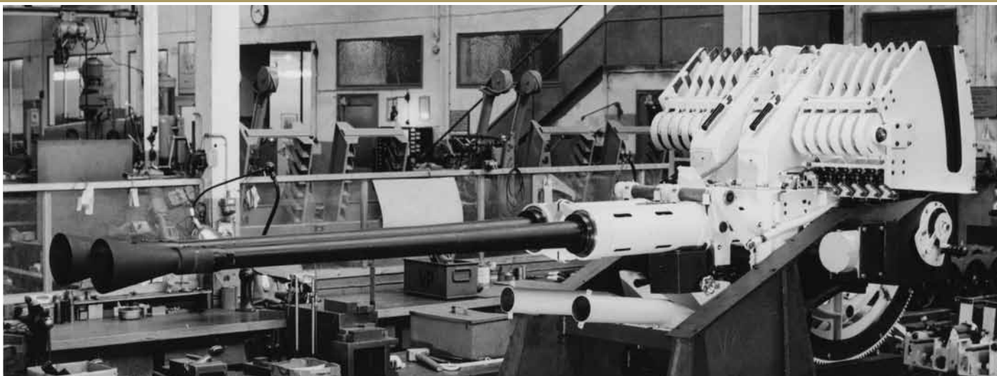
Pjäserna och magasinen hopmonterade, de två vita rör som syns under eldrören är hylsutkasten
