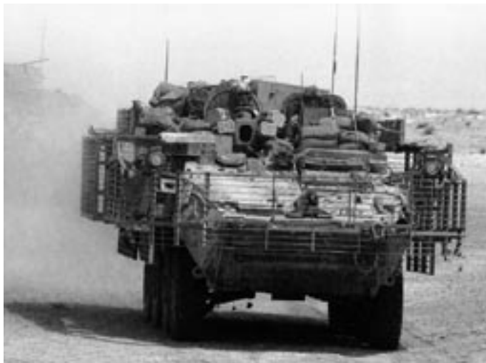
Bild 2: Amerikansk Stryker i Irak försedd med "gårdagens" skydd mot hotet från IED. Foto: US Army Materiel command
