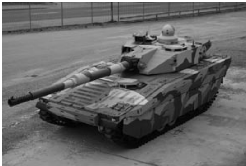
Bild 3: Stridsfordon 90 med 12 cm kanon och sensoraktiverat skyddssystem (AAC) Foto: BAE Systems Hägglunds
