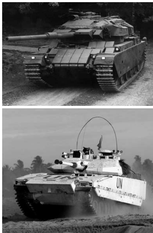
Fig. 20-21. Strv 104 med explosivt reaktivt pansar i jämförelse med Strf 90 C med inert reaktivt pansar. (Foto: FMV respektive Försvarsmakten)
