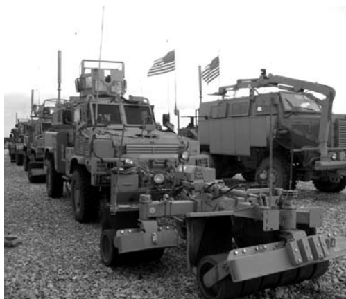
Fig. 33. SPARK (Self Protection Adaptive Roller Kit), minröjningsutrustning för hjulfordon, som även används av Sverige. (Källa: The Office of the Project Manager Close Combat Systems – PM CCS – website http://www.pica.army.mil/pmccs/ )
