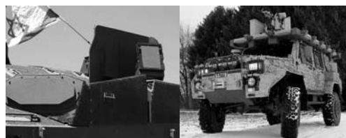
Fig. 16-17. Två olika typer av "Hard-Kill"-system – israeliska ms -systemet Trophy och tyska ms -systemet ADS under utprovning på Tgb 16 "Galten". (Foto: Wikipedia respektive FMV)
