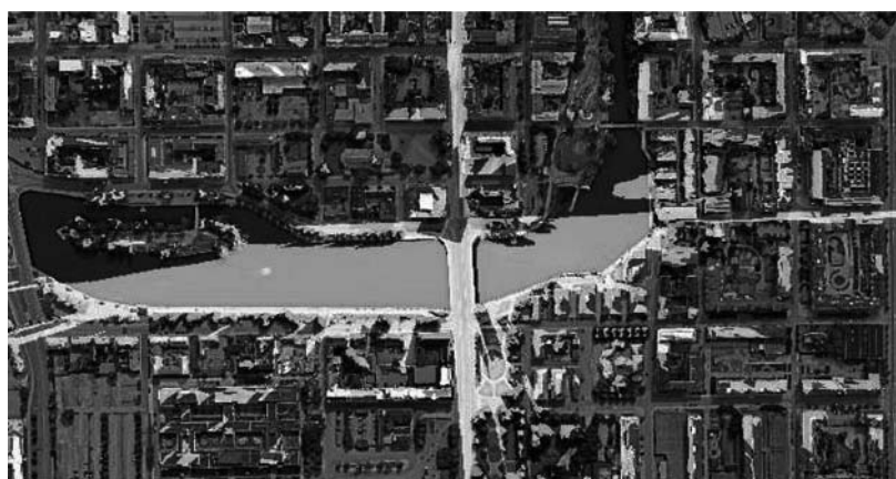
Fig. 10. Generering av 3D-kartor med hjälp av UAV – "På vilken rutt undviks upptäckt?" Gult (ljus) markerade områden är synliga från angiven (fientlig) observationspunkt.
