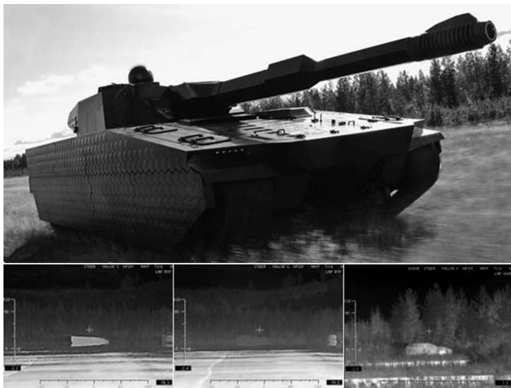
Fig. 12. Exempel på adaptivt kamouflage där ett stridsfordon ”trollas bort” genom att smälta samman med bakgrunden eller där IR-signaturen kan ändras till att likna en personbil. (Foto: BAE Systems Hägglunds AB)
